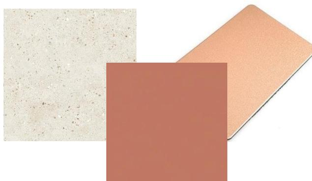
**Especificação:** Cerâmica tipo A, esmaltado, formato 58x58 cm, acabamento Bold (bordas arredondadas), modelo Granito Plus, com junta mínima de 2 mm, aplicado com argamassa colante de alta resistência e rejunte flexível na cor do revestimento ou aproximada até 1,16 m, faixa com chapa de ACM engebold champagne dou metal 4 cm e pintura acrílica na cor terracota até o forro.
